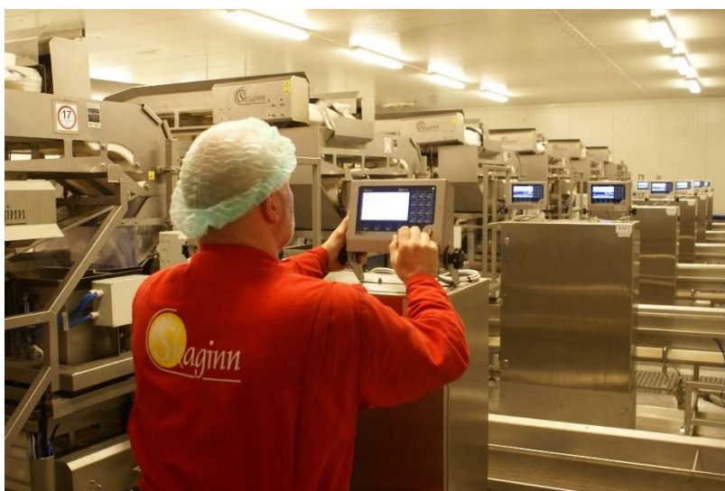
Mynd 13: Uppsetning á nýttísku vélbúnaði frá Skaganum fyrir makrílvinnslu í Færeyjum
